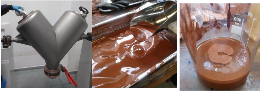
Ilustración 15 Esquema de la vía de preparación de la mezcla híbrida de polvo Metal-sacarosa como precursor al material Metal-grafeno en mezclador v (Metal = Ti6Al4V y Cu).
